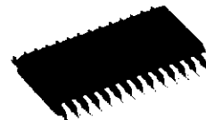
外形 28P2W-A (FP/AFP) 1.27mm pitch 450mil SOP (8.4mm×17.5mm×2.0mm)
